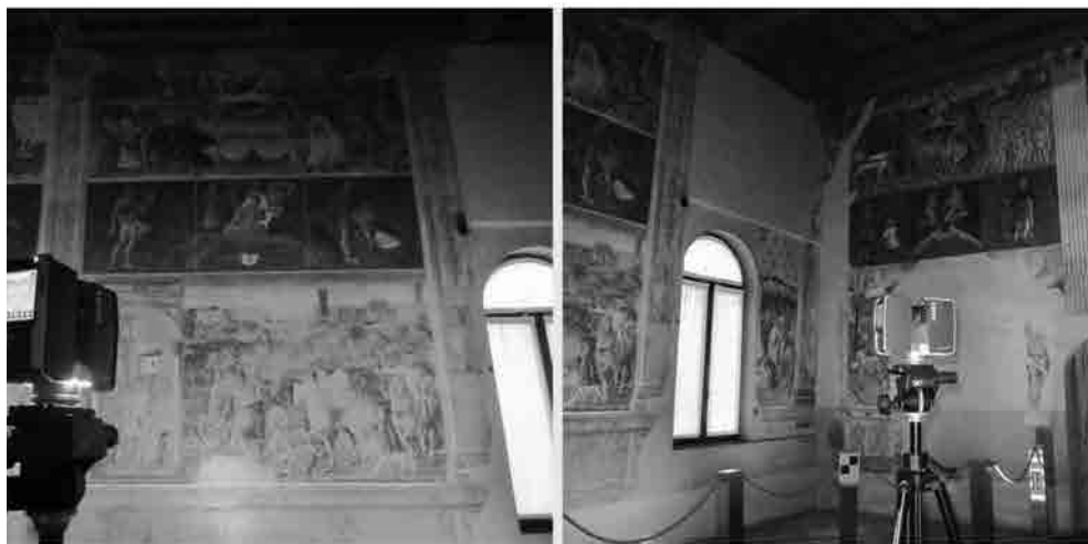
Il laser scanner a differenza di fase Faro Focus 3D .
