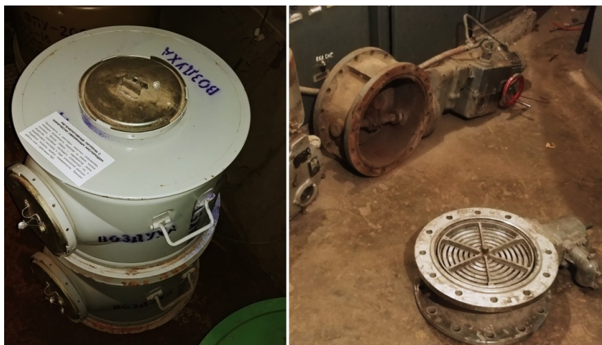
26 | A sinistra, cartucce per il recupero dell'ossigeno a base di biossido di potassio, e valvole a prova di onda d'urto per i canali di aerazione dei bunker, conservate nel museo "bunker 707" a Mosca.
