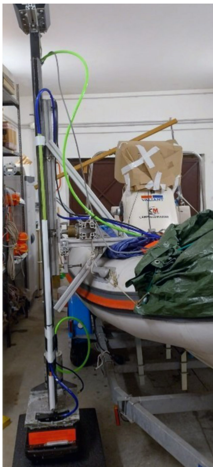
1 | Strumentazioni utilizzate e setup sull'imbarcazione con sistema MBES EM2040P e sistema inerziale e RTK.
