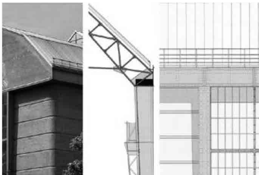
Turbinenfabrik, sistema strutturale verso est
